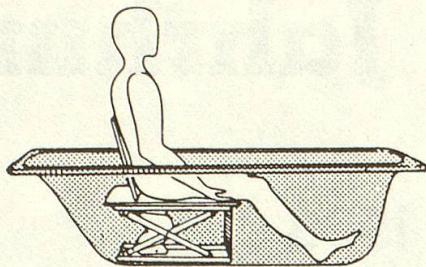
Der AQUA-TEC MINOR-Badelift ermöglicht Badevergnügen ohne gefährliche «Gratwanderung» beim Ein- oder Aussteigen. Der Badelift wird einfach in die Wanne gelegt und am Wasserhahn angeschlossen. Gefährliche Experimente mit Strom werden so von vorneherein ausgeschlossen. Mit einem Kiphebel kann AQUA-TEC MINOR langsam gesenkt, respektive angehoben werden, so dass auf der breiten Sitzfläche bequem Platz genommen werden kann.
