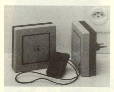
Care-Alarm besteht aus einem kleinen Sender, einem Übertragungsapparat und einem Empfänger. Der Sender übermittelt die Notsignale mit Funk auf das Übertragungsgerät. Von diesem wird das Signal an den Empfänger durch das Stromnetz geleitet.
