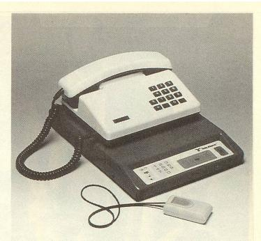
Im Zusatzgerät, das mit Strom betrieben wird, können bis zu vier Telefonnummern frei programmiert werden, darunter kann auch eine Alarmzentrale sein. Diese vier vorprogrammierten Nummern werden bei Alarmauslösung automatisch angerufen, viermal jede Nummer, sollte keine Antwort erfolgen. Anschliessend muss ein neuer Alarm ausgelöst werden.
