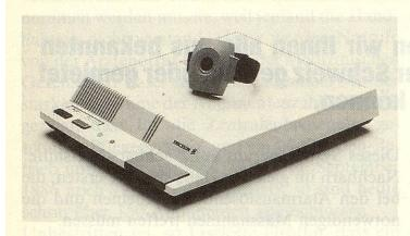
Das Ericare besteht aus zwei Geräten: Dem Notruftaster und dem Ericare-Gerät. Der Notruftaster ist wasserdicht und wird wie eine Armbanduhr um das Handgelenk getragen. Er vermag innerhalb eines Einfamilienhauses, also auch innerhalb einer Wohnung, den Alarm auszulösen.
