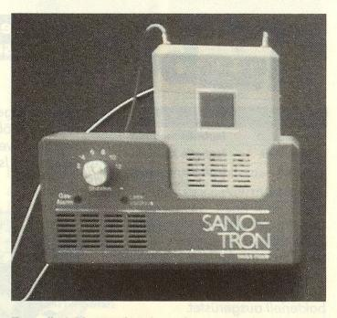
Das SANO-TRON besteht aus zwei Geräten: dem Ladegerät (145 × 75 × 45 mm) und dem Traggerät (70 × 110 × 20 mm, Gewicht 150 g). Dieses wird mit einem Akkumulator betrieben und lädt sich jede Nacht, in das Ladegerät gesteckt, wieder auf.
