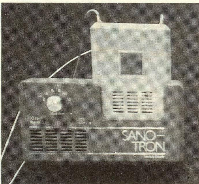
Das SANO-TRON besteht aus zwei Geräten: dem Ladegerät (145 × 75 × 45 mm) und dem Traggerät (70 × 110 × 20 mm, Gewicht 150 g). Dieses wird mit einem Akkumulator betrieben und lädt sich jede Nacht, in das Ladegerät gesteckt, wieder auf.
