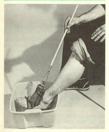
Entwickelt wurde dieses einfache Gerät (Holzstiel, versehen mit zwei Klammern) für Leute, die beim Füssewaschen Mühe haben, weil sie den Rücken nicht mehr so stark beugen können. Ein Schwamm oder Waschlappen wird zwischen die Greifer geklemmt. Füsse und Beine können so ohne grosse Mühe gewaschen werden.
