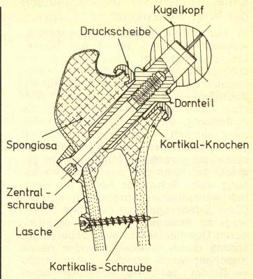
Die neue Hüftendoprothese im Querschnitt. Vorteile: Zementlose Verankerung im Knochen; der Markraum des Röhrenknochens muss nicht eröffnet werden. Abstützung direkt auf dem kompakten Knochen des Schenkelhalses.
