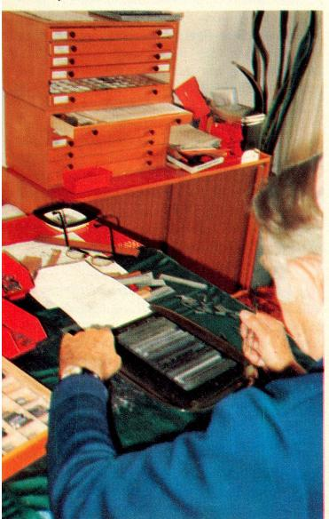
stellt sie in die laufende Zeile, ein Blick zum Manuskript, ein Trennungszeichen, die Linie ist gefüllt. Jetzt wird sorgfältig ein dünner Aluminiumstreifen als Zwischenraum eingelegt, dann beginnt die neue Zeile.
