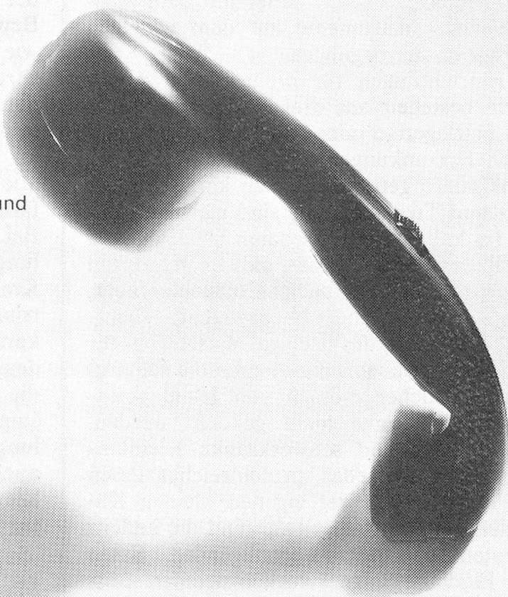
Dieser Hörer kann ohne weiteres an jeden Telefonapparat angeschlossen werden. In seinem Griff ist ein kleiner transistorisierter Mini-Verstärker eingebaut, der vom Telefonmonteur genau nach Ihrer Hörfähigkeit eingestellt wird. Die Lautstärke können Sie mit einem kleinen Drehknopf stufenlos regulieren. Ganz Ihrem Wunsch gemäss stellen Sie lauter oder leiser ein – auch während des Telefonierens.
