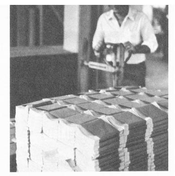
Die in 50er Bündel abgepackten Prospekte werden auf Paletten geschichtet. Am Schluss sind es an die 10 Tonnen Papier, die per Bahn, Camion oder Post an die Empfänger spediert werden.
