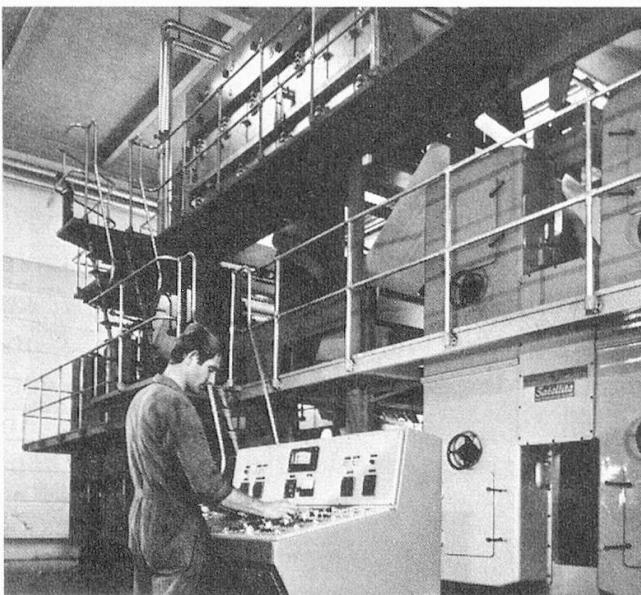
*Fast so gross wie ein Einfamilienhaus ist diese Offset-Rotationsmaschine in Köniz. Sie spuckt pro Minute 150 Bogen aus und kostet die Kleinigkeit von etwa 2 Millionen Franken.*
