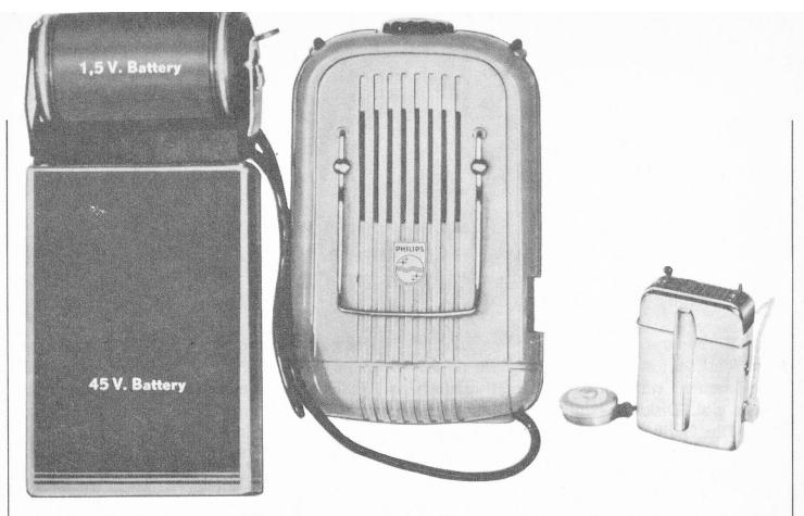
25 Jahre Entwicklung von Hörgeräten: Den eindrücklichen technischen Fortschritt zeigt deutlich unser Grössenvergleich im gleichen Massstab. Links ein Gerät von 1947 mit Batterieeinheit und dem eigentlichen Verstärker mit Röhren und Mikrofon.
