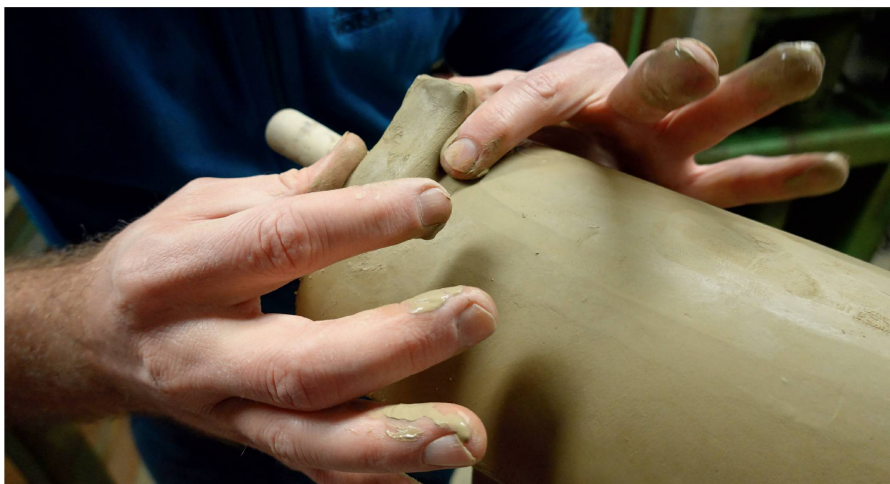
Hannes Flück formt eine Nase an einem Unterliegerziegel für die Burg Neu-Aspermont. (Foto Jürg Goll)
