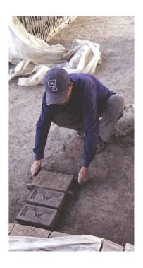
Abb. 4 Modelgeformte Backsteine.
