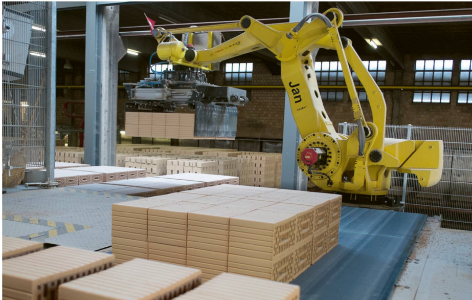
Der Entladeroboter Jan greift die gebrannten Steine ab dem Tunnelofenwagen.
