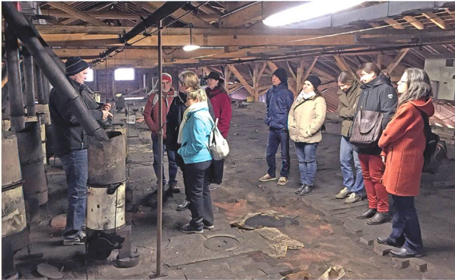
Teamausflug in die Ziegelei Lanter in Hochfelden F. Bruno Lanter erklärt die Beschicker auf dem Ringofen.
