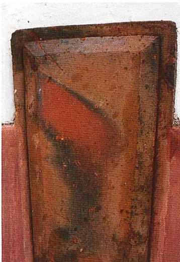
Abb. 3–5 Fragment einer Originalsäule. Verzogene Säule mit versinterter Oberfläche. Schlussstein mit Spuren des Brennprozesses.
