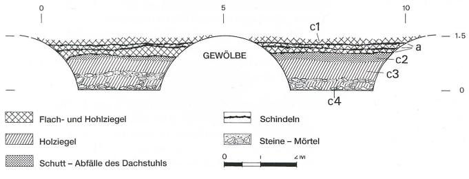
Der Schichtaufbau ist in allen untersuchten Abschnitten unter dem Dach des Mittelschiffs und der Seitenschiffe einheitlich. Nur unter dem Vierungsturm, der Ende des 15. Jahrhunderts errichtet wurde<sup>9</sup>, weicht die Stratigrafie davon ab: Hier sind die Rechteckschnitte und die Korbbogenschnitte<sup>10</sup> in allen Schuttschichten, auch in tieferen Lagen, omnipräsent, was auf eine abweichende Ziegeldeckung des Glockenturms schliessen lässt.
