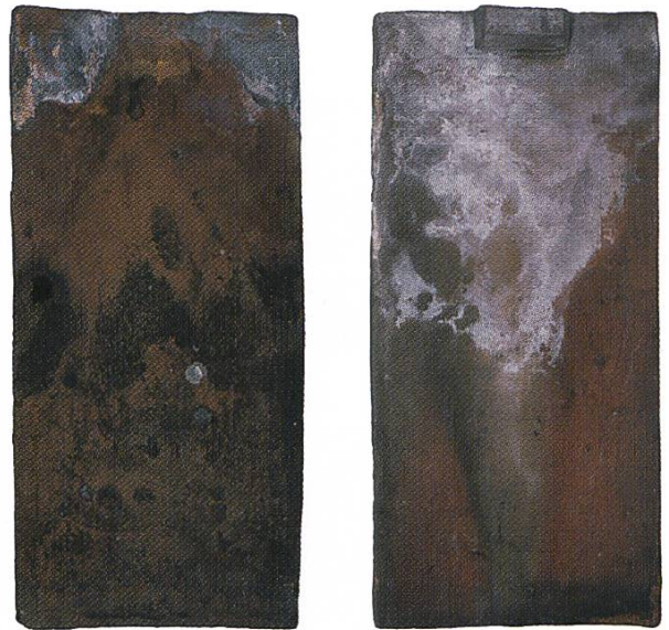
Abb. 10 Hirsau, St. Aurelius. Langer Rechteckschnitt für den Traufbereich. Vorder- und Rückseite, 1:10.
