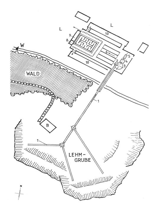
den auf eine Feuchtigkeit von zirka 5% heruntergetrocknet, bis er für den Brand im Zickzack-Ofen bereit war. Nach dem Brand wurden die gebrannten Tonprodukte auf spezielle Dreiradwagen geladen, in die Lagerschuppen gefahren und dort auf Holzpaletten gestapelt.
