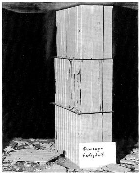
Abb. 3 Versuchseinrichtung der Querzugfestigkeit.
