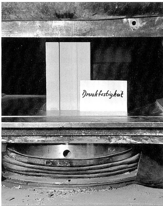
Abb. 1 Versuchseinrichtung der Druckfestigkeitsprüfung.
