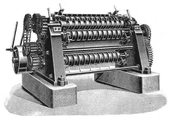
Abb. 10 Steinaussonderungswalzwerk von Kuhnert (Vierwalzenausführung). Kuhnert & Co., Meissen. Die meisten Steinaussonderungswalzwerke – auch die heutigen Ausführungen – besitzen nur zwei Walzen, wovon die eine mit einem Gewinde versehen, die andere glatt ist (Abb. 11).
