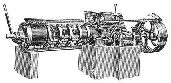
deren Durchmesser bis auf 1 mm heruntergehen konnte. Die Wurzeln, Steine und anderes wurden weitertransportiert, sammelten sich im Presskopf an und wurden von dort durch zeitweiliges Öffnen des Schiebers entfernt. Dieser Tonreiniger wurde nach Ablauf des Patents 1920 von vielen Ziegeleimaschinenherstellern nachgebaut. Eine moderne Ausführung ist der 1960 patentierte Kneter-Filter der italienischen Firma Bedeschi.
