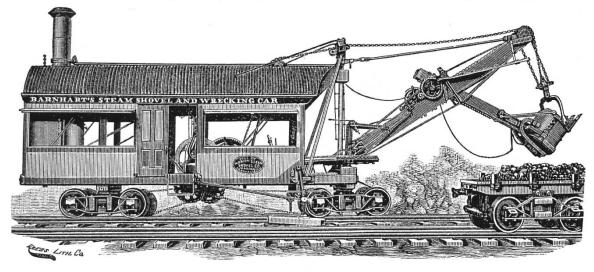
Abb. 1 Löffelbagger um 1898, sog. «Dampfschaufel». schinen. So unterschied man Fabriken für gemischte Fertigung, wie zum Beispiel die 1860 als Giesserei gegründete Firma Gebr. Bühler in Uzwil, die von 1899 bis 1959 Ziegeleimaschinen baute, und Firmen mit spezialisierter Fertigung, die ausschliesslich Ziegeleimaschinen herstellten, wie zum Beispiel die deutschen Firmen Händle in Mühlacker und Rieter in Konstanz.
