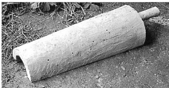
Abb. 9: Form für Backsteine mit trapezförmigem Querschnitt: Holz, vierteilig, auf einer Seite mit Eisenstab verstärkt, kleine rechteckige Einkerbung in der Längsseite. Innenmass 27,5 x 10 x 5–6,5 cm.
