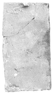
Abb.3 Ziegel vom Schloss Grandson, Anfang 14. Jh., mit umgeschlagener Nase. Die Oberfläche ist rauh und gesandet, die Rückseite wurde abgezogen und geglättet (MHAVD 117/34).
