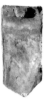
Abb. 4 Ziegel vom Nordostturm des Schlosses Lutry mit Pressfalten auf der Oberfläche. Die Rückseite wurde abgezogen und danach die Nase umgeklappt und nachbearbeitet (MHAVD 147/93).
