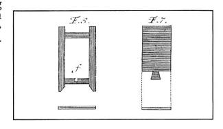
Diese Ziegeltypen, meistens von kleinen Dimensionen, wurden nur auf der Rückseite geglättet. Die rauh belassene Oberfläche ist für sie charakteristisch. Diese kann gar nicht mit einem Wasserstrich versehen worden sein, denn sie lag stets gegen unten gekehrt auf einem mit Sand bestreuten Untergrund, der das Ankleben des Ziegels während der Formgebung verhinderte. Nicht selten sind auf der Oberfläche Pressfalten zu beobachten (Abb. 3 + 4).
