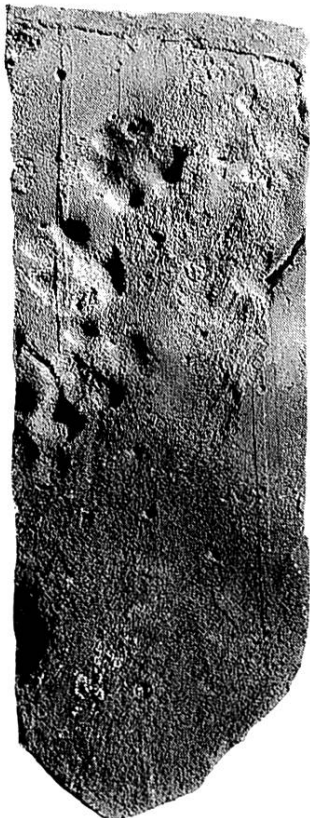
Abb. 16 Tierpfoten- abdrücke auf der mit einem Werkzeug abge- zogenen, kannelierten Ziegel- oberfläche (Ziegel vom Vierungs- turm der Kathedrale Lausanne, MHAVD 132/60).
