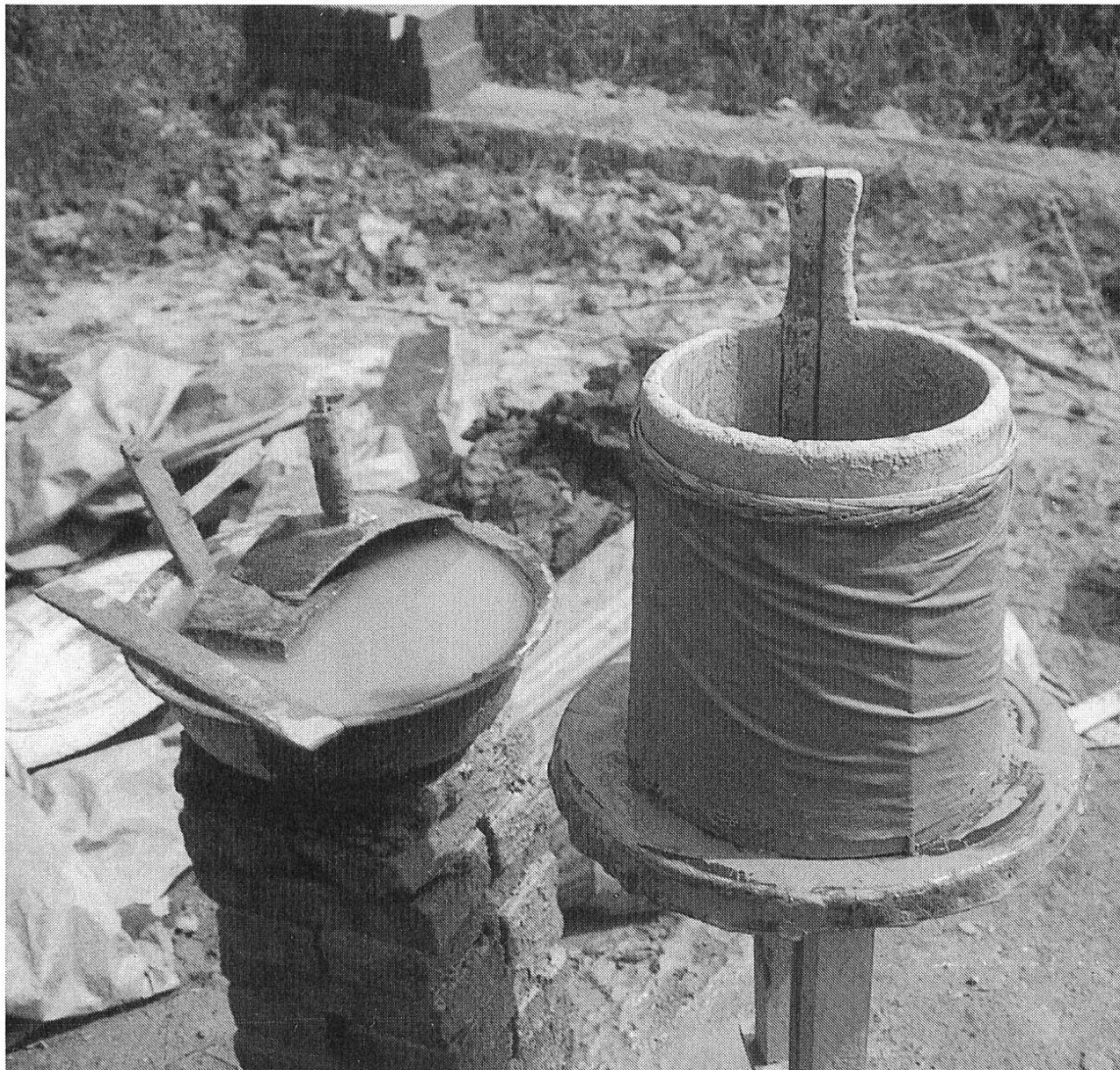
Abb. 8 Drehscheibe mit «Holzkübel» für die Ziegelproduktion. Unter der Tuchbespannung verbirgt sich ein senkrechter Steg, der das Zerbrechen in einzelne Ziegelschalen erleichtert.
