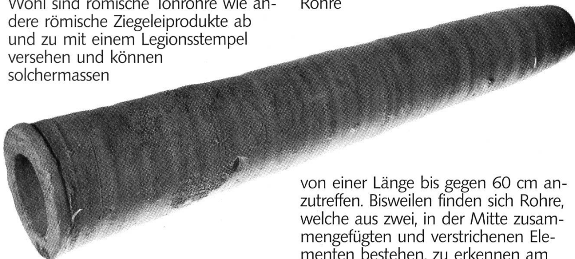
Abb. 4 Römisches Tonrohr von Vindonissa, Länge: 55 cm (ZMM Reg.- Nr. 1016)
