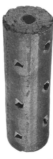
In Österreich verwendetes Tonrohr zur Stabilisierung von Polygon-Vermessungspunkten (L: 21,5 cm; Ø: 6,2 cm) kannt und deshalb das fragliche Exponat und die dazugehörenden Unterlagen nicht mehr auffindbar sind.
