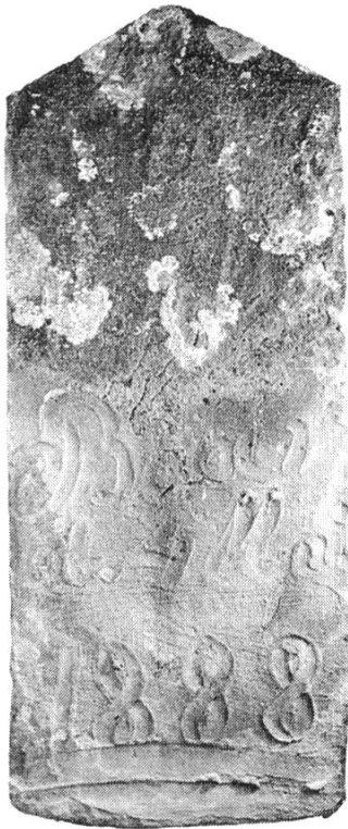
Reg.-Nr. 301, «langer» Ziegel- typ, Baar, Ster- nenweg, mit eingestrichenem Herstellungsort: «Baar d. 4. Mai 1888»
