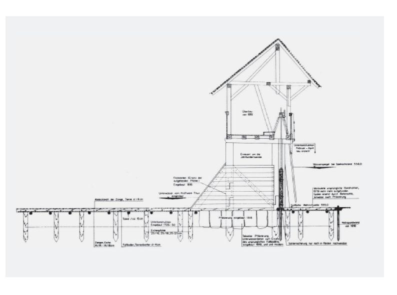
Querschnitt von 1936 durch die obere Staatsschleuse in der Äusseren Aare in Thun. Die Schleuse wurde um 1726 erstellt, 1818 erneuert und seitdem mehrmals überholt. - Aus: Neumann (wie Anm. 6), 181.
