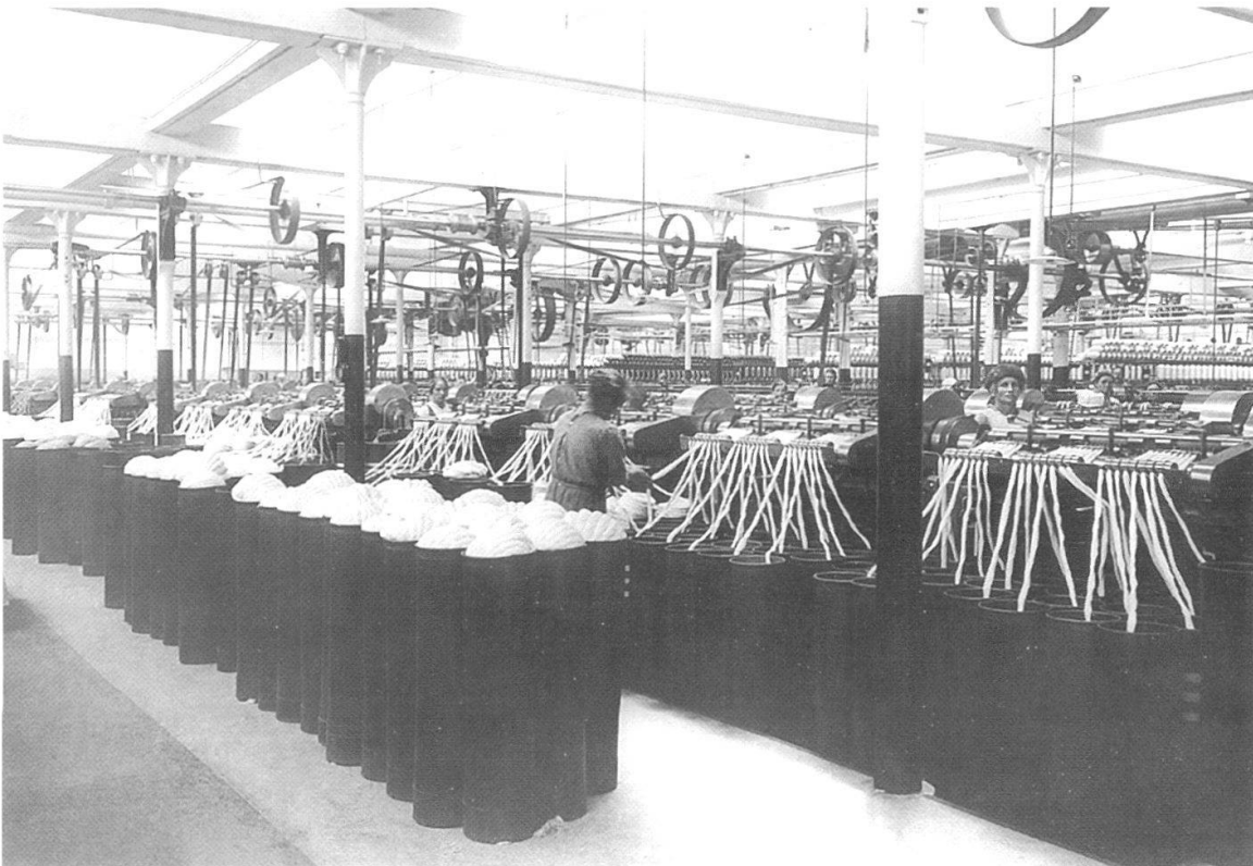
Abb. 9 Ein Saal der Spinnerei Felsenau in der Zwischenkriegszeit. Die in «Kannen» von der Karderie angelieferten Baumwollbänder wurden hier in die Flyermaschinen eingeführt, die das Band streckten und leicht drehten. So entstand das Vorgarn von einigen Millimetern Dicke, das im nächsten Arbeitsgang zu Garn gesponnen wurde.
