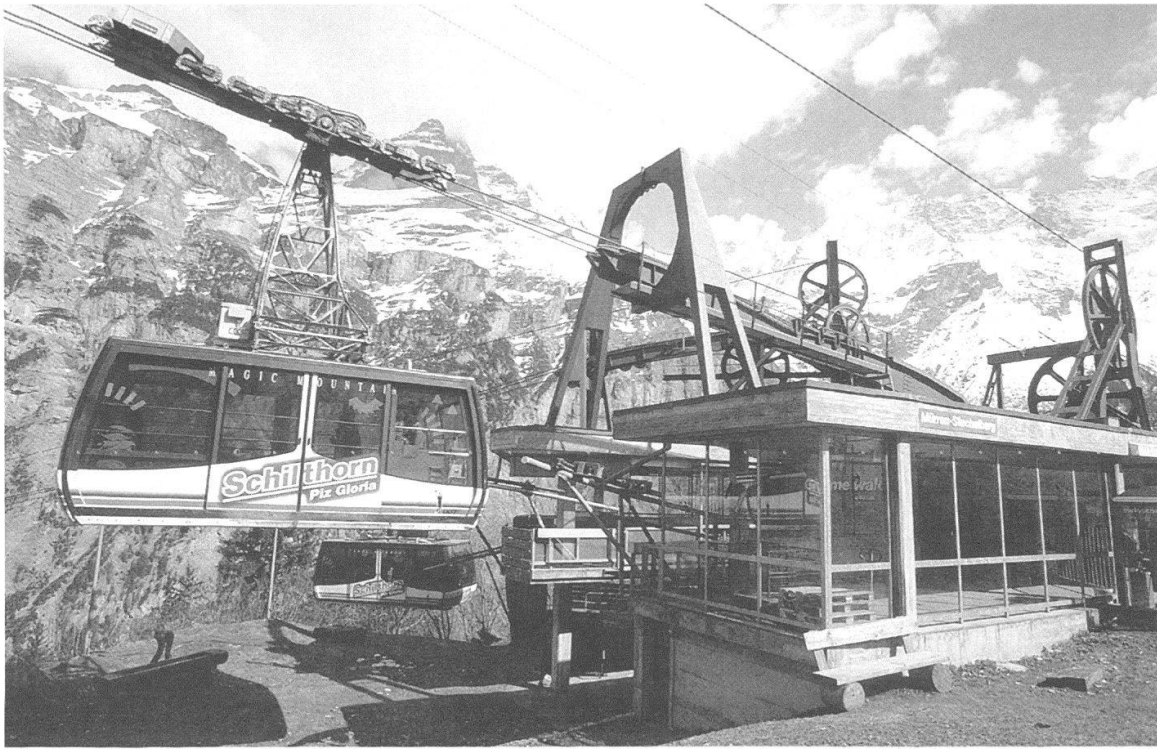
Abb. 4 Heutige Schilthornbahnkabinen. In Gimmelwald werden die durchgehenden Seile in spitzem Winkel umgelenkt. Foto (21.4.2006), Daniel Bernet, Bern.
