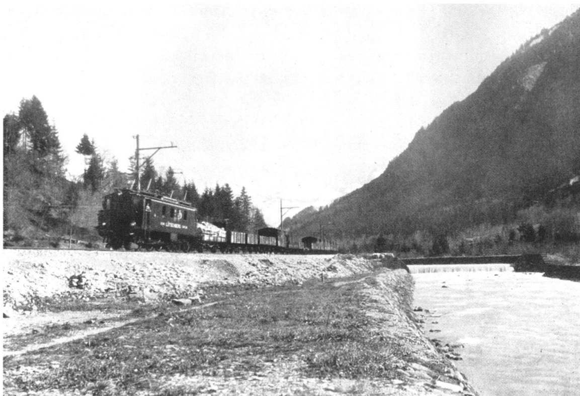
Abb. 10 Die Lokomotive der Lötschbergbahn ist um 1911 unterwegs entlang der Kander zwischen Heustrich und Spiez. Die MFO baute für die BLS die damals stärkste Lokomotive der Welt (Nr. 121). Damit sie zwischen Spiez und Frutigen verkehren konnte, wurde die Kander korrigiert.
