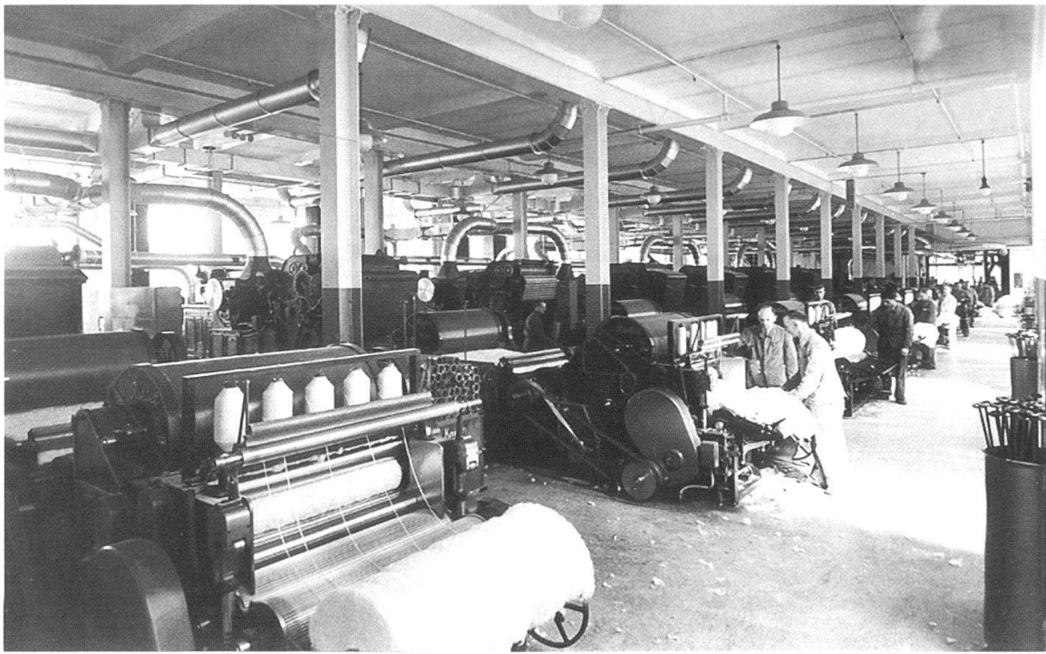
Abb. 8 Die Battage-Abteilung um 1945. Die Maschinen lösten die Baumwolle in Flocken auf, reinigten und mischten sie. Aus den Batteuren kam der Wickel heraus, ein Baumwollfließ, das auf Rollen aufgewickelt wurde, bevor man es in der Karderie weiter verarbeitete.
