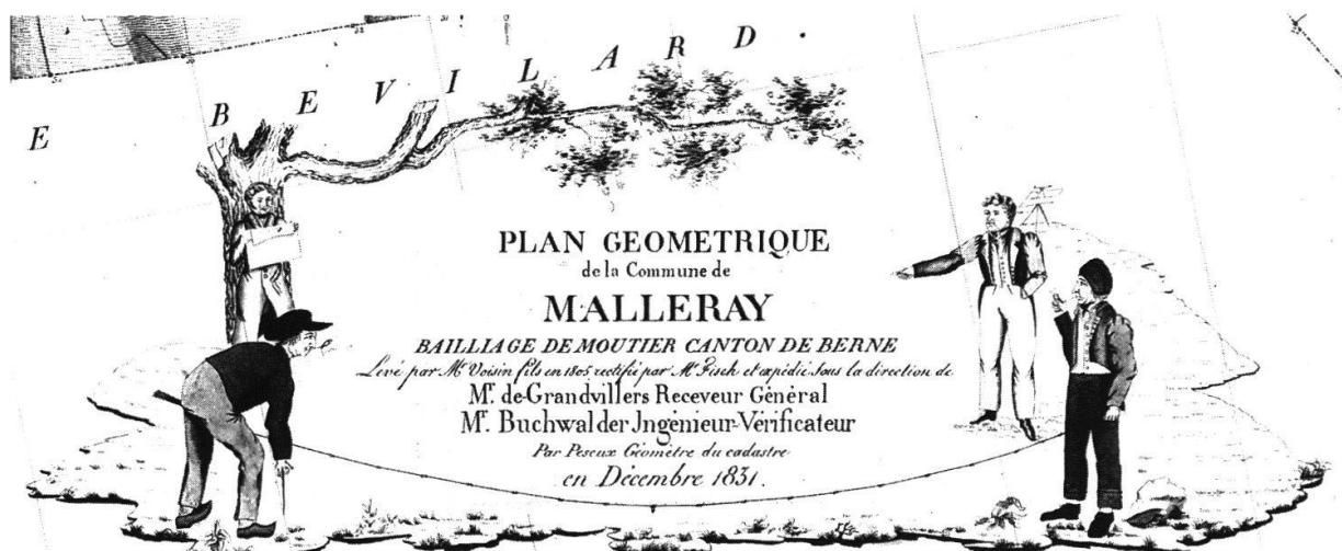
Le plan général par masses de culture de Malleray (1831) est agrémenté d'un dessin représentant les arpenteurs géomètres au travail. Ils sont aidés de deux porte-chaînes. Les différentes Instructions aux géomètres ont systématiquement omis la pipe dans la liste des principaux instruments d'arpentage! (AA IV Moutier 12).
