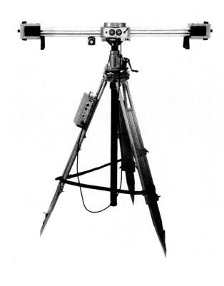
Abbildung 19 Weitwinkel-Stereometer-Kammer Wild C 120
