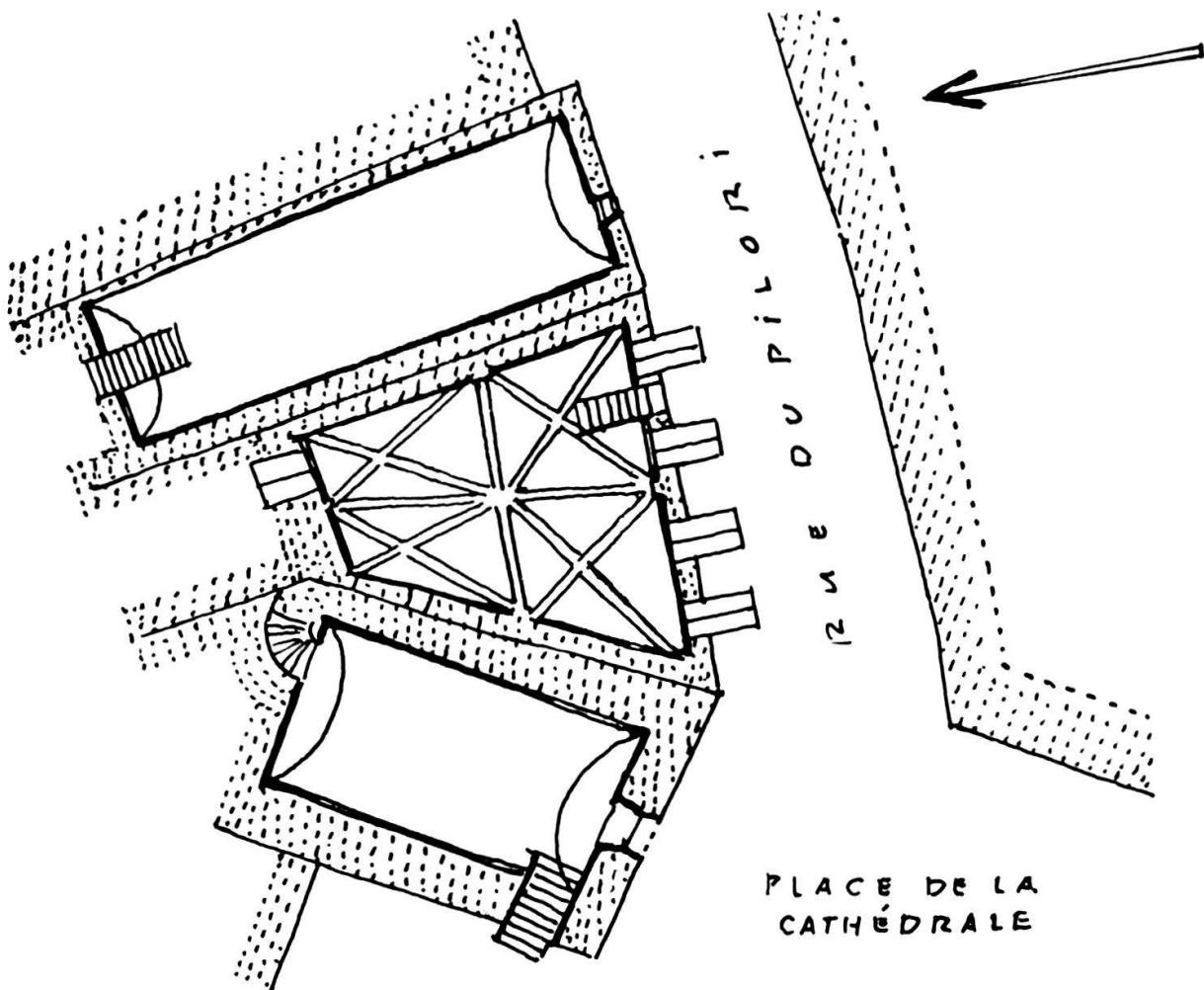
Abb. 2 BAYONNE, place de la Cathédrale. Kellergruppe mit Kreuzrippen- und Tonnengewölben. Nach É. LAMBERT a.a.o. II, 1956. Kreuzgewölbe: 14. Jahrhundert. Tonnengewölbe: ab 16. Jahrhundert.
