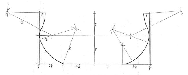
Abb. 4 Rekonstruktionsmöglichkeiten für das Hauptspant
