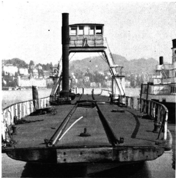
Das ehemalige Thunersee-Trajektschiff (Eisenbahnfähre) Nr. 2, 1886—1893, der Bödelibahn. Gebaut von Escher Wyß & Cie., Zürich. Ca. 43 m lang, kann es 5—6 beladene Eisenbahn-Güterwagen aufnehmen. Seit 1896 auf dem Vierwaldstättersee, bis 1931 im Besitz der dortigen Dampfschiffgesellschaft, dann der Seeverlad- und Kieshandels A. G. Luzern. Die Steuerbrücke war ursprünglich offen, sie ist erst nach 1920 gedeckt worden. — Aufnahmen Volmar im Hafen von Luzern, März 1946.
