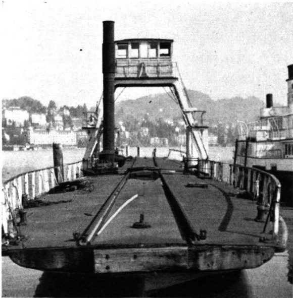
Das ehemalige Thunersee-Trajektschiff (Eisenbahnfähre) Nr. 2, 1886—1893, der Bodelibahn. Gebaut von Escher Wyß & Cie., Zürich. Ca. 43 m lang, kann es 5—6 beladene Eisenbahn-Güterwagen aufnehmen. Seit 1896 auf dem Vierwaldstättersee, bis 1931 im Besitz der dortigen Dampfschiffgesellschaft, dann der Seeverlad- und Kieshandels A. G. Luzern. Die Steuerbrücke war ursprünglich offen, sie ist erst nach 1920 gedeckt worden. — Aufnahmen Volmar im Hafen von Luzern, März 1946.
