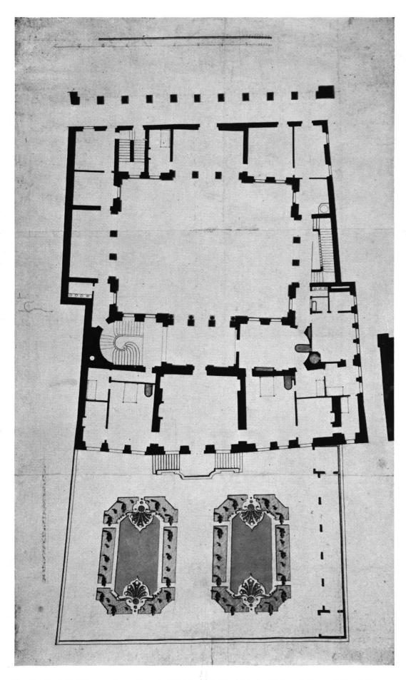
Zweites Projekt (B), von demselben Architekten wie Projekt A. (Erdgeschoßgrundriß mit Gartenplan); es ist ein Viereckhof mit zweigeschoßig ausgebautem Trakt an der Junkerngasse vorgesehen; Vestibul und Haupttreppe im Südflügel befinden sich bereits da wo heute.
