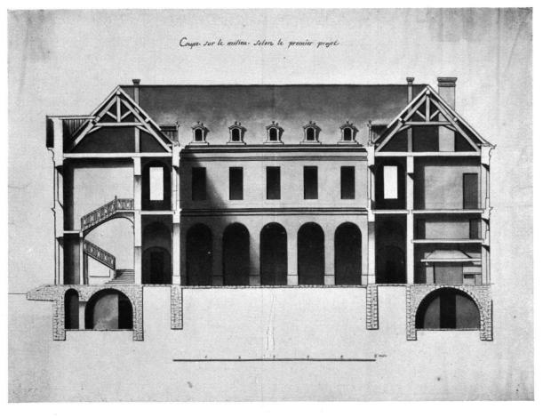
Abb. 2. b) Querschnitt durch den Südflügel (Hauptgebäude) mit der Haupttreppe und durch den zweigeschoßigen Wohntrakt an der Junkerngasse.
