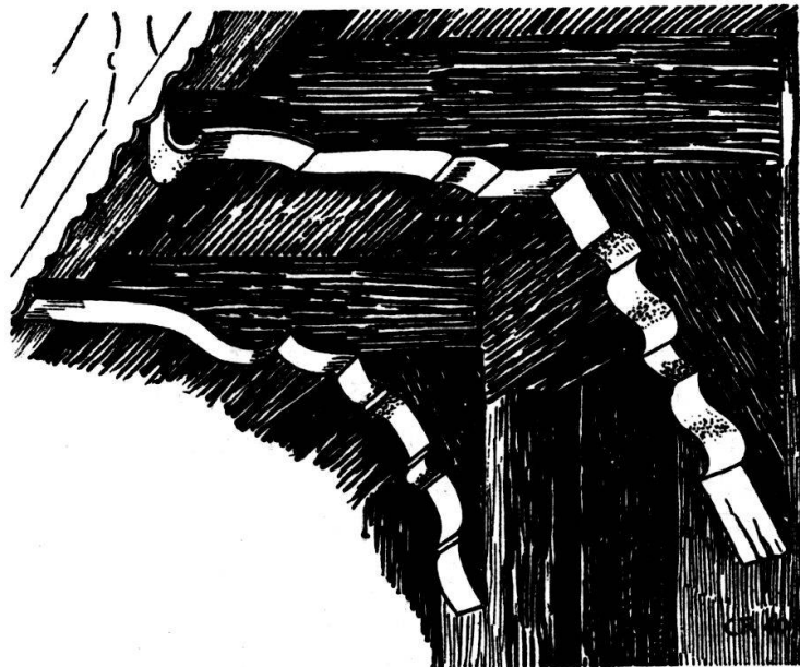
Abb. 6. An den Seiteneingängen des Hauses reichen sich zwei Bauepochen die Hände. Links der Türe stützen die elegant geschnittene Pfette und die Konsole aus dem Jahre 1829 die Laube. Rechts dagegen wächst wuchtig die Konsole des Jahres 1685 aus der Wand heraus und führt den gleitenden Blick auf die Pfette mit ihrem charakteristischen Abschlußwulst.
