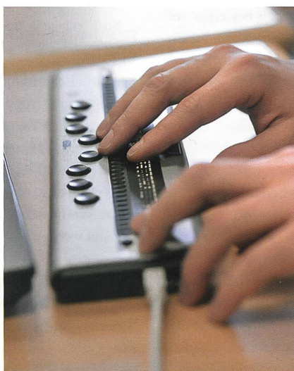
Die Braillezeile übersetzt in Punktschrift.
