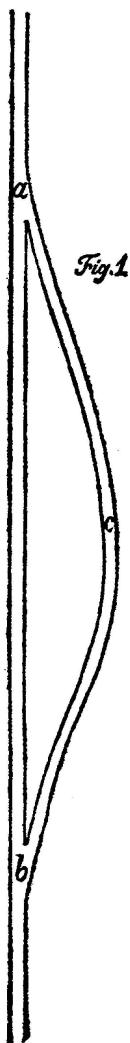
gerade Straße ab befahren wird, und  $T^1$  die Zeitdauer, in welcher mit gleicher Belastung  $P$  die gebogene Straße ab befahren wird, so ist auf ersterer in jeder Zeiteinheit der Bewegungswiderstand gleich  $\frac{Q}{T}$  und auf letzterer gleich  $\frac{Q^1}{T^1}$ . Soll daher auf der gebogenen Straße die Zugkraft zur Ueberwindung dieses Bewegungswiderstandes nicht stärker angestrengt werden, als auf der geraden Straße, so muß  $\frac{Q}{T} = \frac{Q^1}{T^1}$ , folglich
