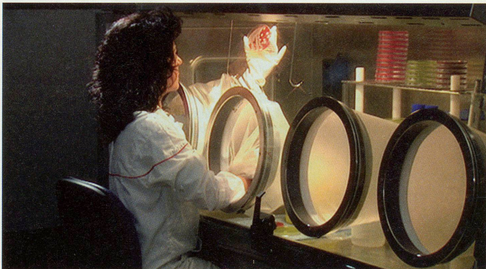
Für den Nachweis von Anthrax sind besondere Sicherheitsmassnahmen erforderlich. Das LABOR SPIEZ verfügt dazu über eine spezielle Sicherheitswerkbank.
