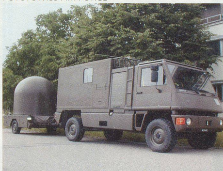
P-763+: die mobilen Elemente zum Start von Wetterballonen bei der Artillerie.
