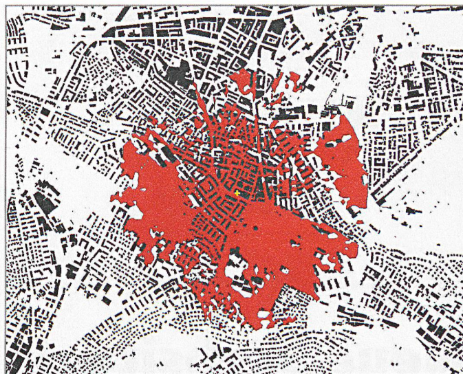
Isophonfläche > 70 dBA unter Berücksichtigung der Topographie und der Gebäudehöhen. Dabei sind die Lücken klar ersichtlich.
