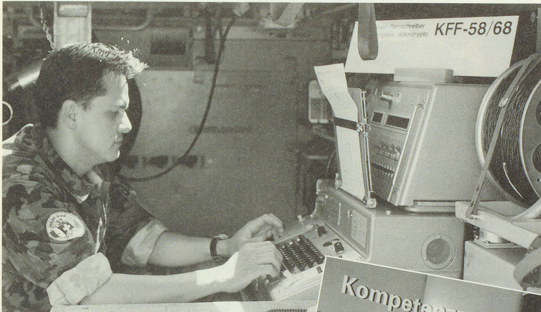
Funkpionier Louis Monsch am Funkfern-schreiber des KP einer Panzerbrigade. Das System wurde 1962/64 eingeführt.
