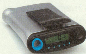
Dosimetro elettronico (EDOS 99).
