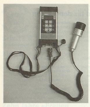
Dosisleistungsmessgerät mit Sonde (RA99).
