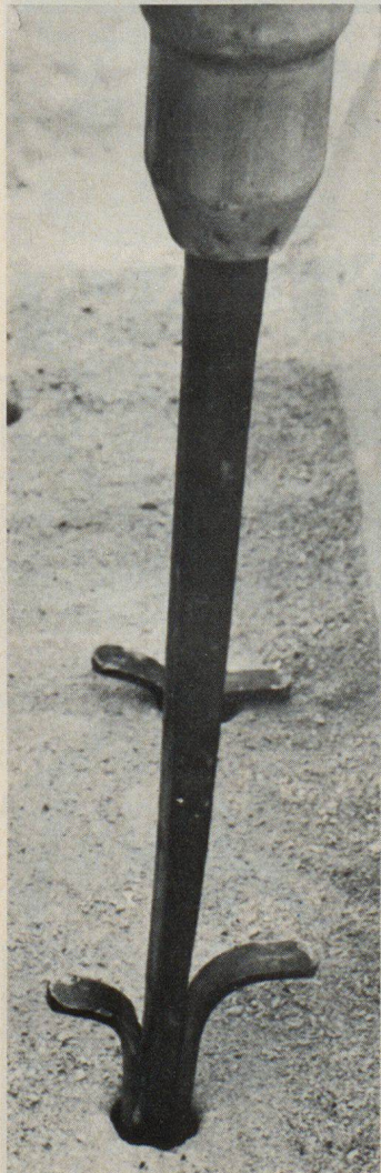
Fig. 27. Joutes de clivage dans forures en ligne
