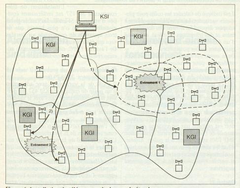
Figure 6: Installation de télécommande de grande étendue.
