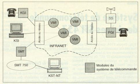
Figure 1: Principe de fonctionnement de la télécommande SFI 457.
