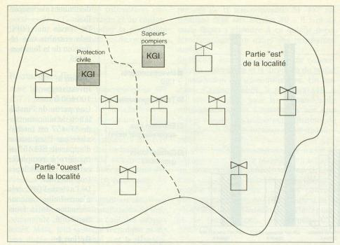
Figure 5: Installation de télécommande de faible étendue.
