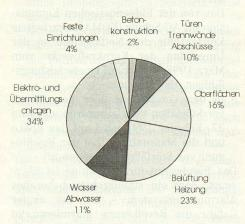
Figur 3: Anteile der verschiedenen Bauteile am Finanzbedarf für die Erneuerung in den nächsten 30 Jahren.
