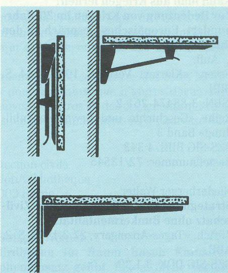
Überall, wo Sauberkeit und Hygiene verlangt wird, sind die von HEBGO hergestellten Konsolen aus Chromnickelstahl A2 gefragt. Diese neu im Verkaufsprogramm aufgenommenen Träger sind in der Ausführung als feste Konsolen oder Klappkonsolen in den Ausladungen von 330 bis 780 mm erhältlich.
