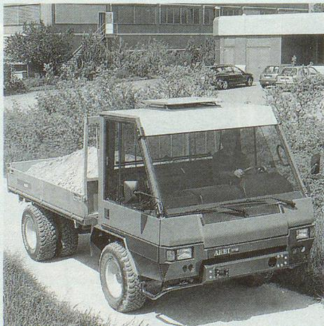
Le Transporter Aebi TP 98 redéveloppé a un poids total de 7,5 tonnes, déplace de hautes charges utiles, tout en étant extrêmement fiable en pentes.
