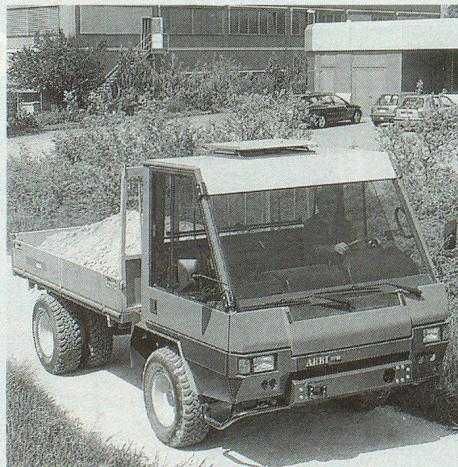
Le Transporter Aebi TP 98 redéveloppé à un poids total de 7,5 tonnes, déplace de hautes charges utiles, tout en étant extrêmement fiable en pentes.
